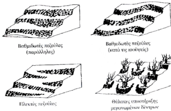
Εικόνα 19. Είδη αναβαθμίδων κατά Rackham & Moody (πηγή: Rackham & Moody 2001).
