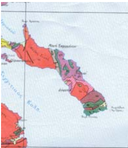
Εικόνα 8. Γεωλογική συγκρότηση της λεκάνης του χειμάρρου Αεροπόταμος. Figure 8. Geological constitution of basin of torrent Aeropotamos.
