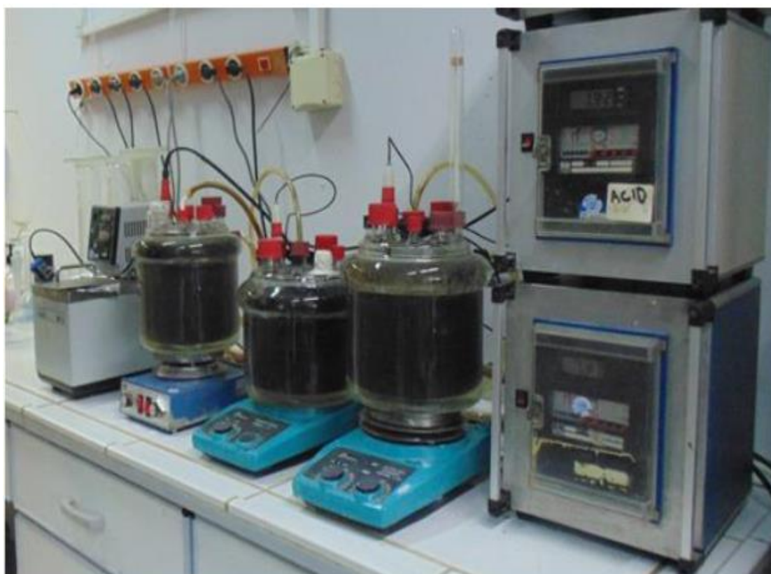
Εικόνα 5. Φωτογραφική απεικόνιση των αντιδραστήρων παραγωγής βιοαερίου στο Εργαστήριο Διαχείρισης και Τεχνολογίας Υγρών Αποβλήτων του ΔΠΘ.
